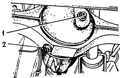
Фиг. 47. Отвори за контрол и източване в задния мостъ 1, 2 — пробки
